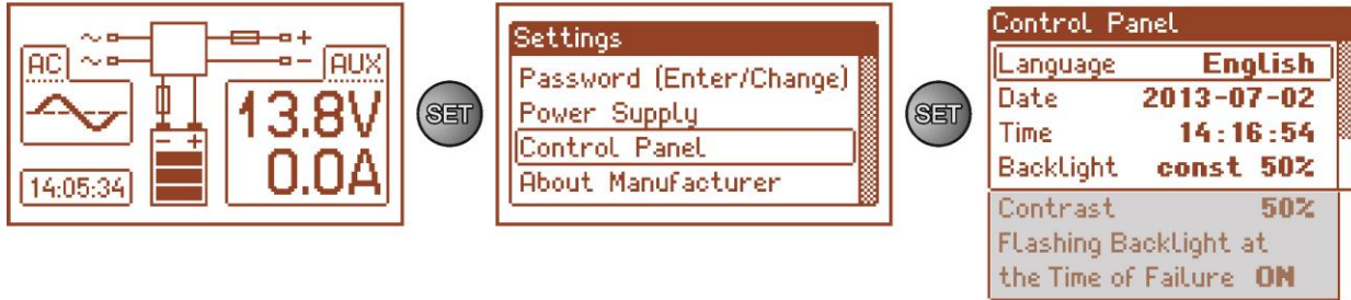
Fig. 23. „Control panel” screen.
